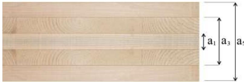
**Figura 2. Schematizzazione di un pannello XLAM con indicazione degli spessori di riferimento per il calcolo dei moduli elastici equivalenti secondo il K Method.**
