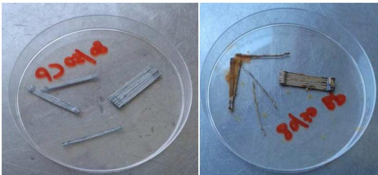
Fibre anticorrosione, prova superata
