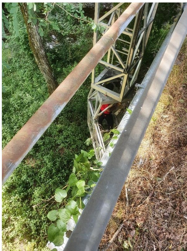
Figura 2. Discesa dell'operatore con piattaforma ai fini del prelievo di carota di cls.
